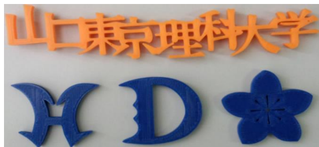
図 2 熱溶融積層造形型の 3D プリンタで造形したモデル
