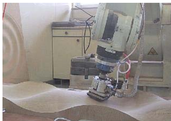
図1 ロボットサンダーによる大型曲面ワークの研磨風景 (インテリア研究所：大川市)
