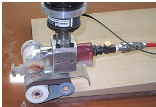
図-3 エア駆動のベルト式研磨工具
