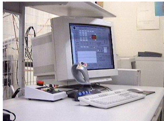
図-2 開発したジョイスティック支援による教示システム
